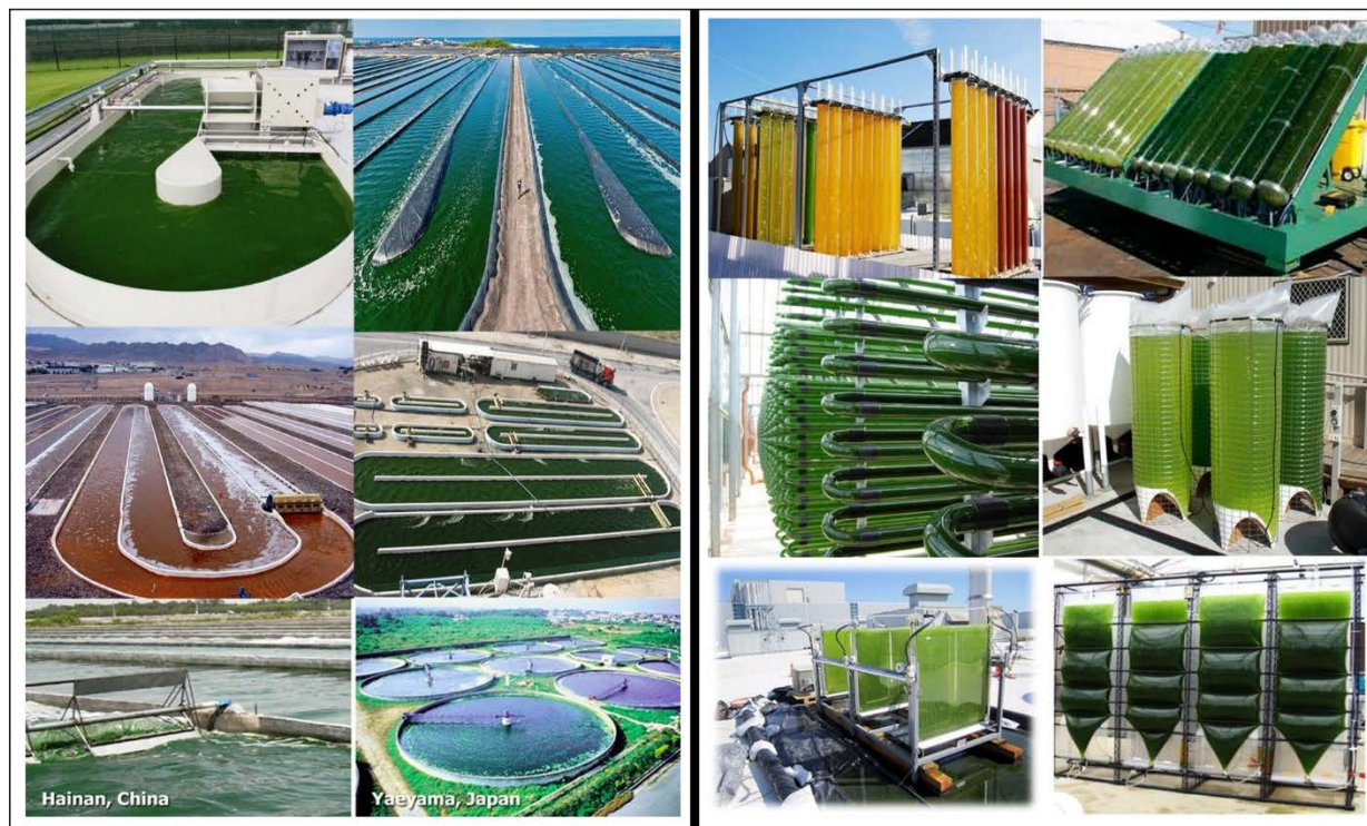
شکل ۳. نمایی از سیستم های کشت ریز جلبک حوضچه های روباز و بیوراکتور ها
