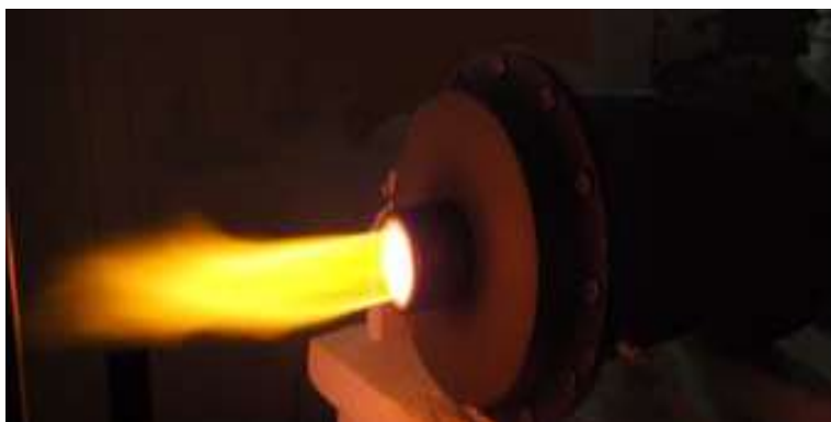
شکل ۳- ایجاد پلاسما گرم بوسیله الکتریسیته و هوا به منظور تولید انرژی پاک برای صنایع سنگین (Clean Electric Flame)
