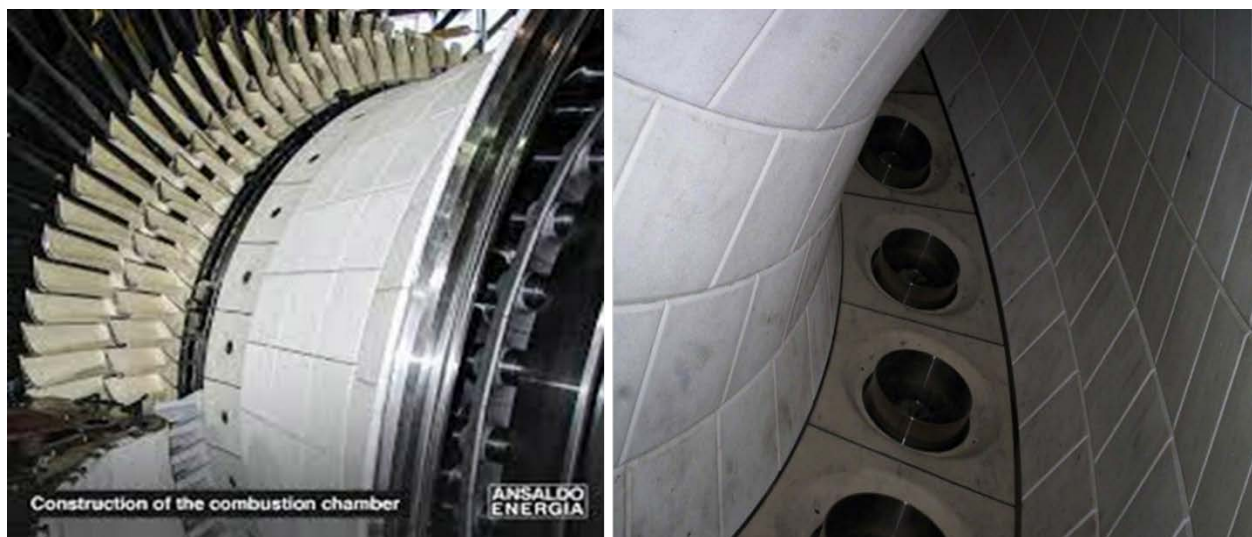
شکل ۱. کاربرد فراورده و سرامیک‌های نسوز در بدنه بیرونی و محفظه احتراق توربین
